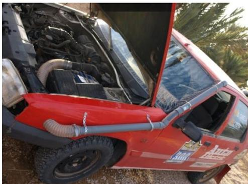
Diesen Ansaugstutzen fand ich originell. Das ganze Teil ist aus alten Sanitärrohren gefertigt und am Kotflügel angenietet.
