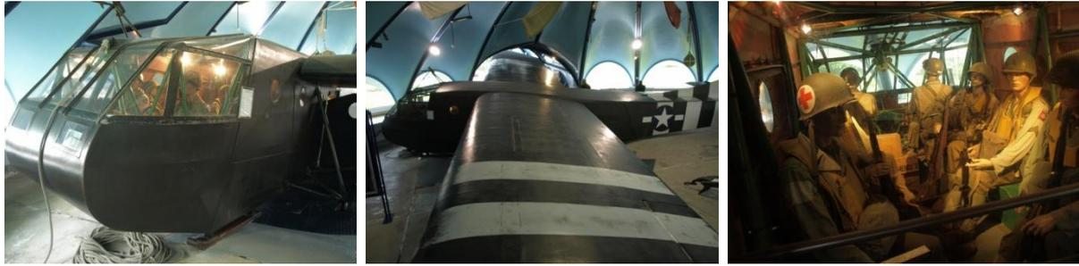
Tausende solcher Lastensegler wurden eingesetzt um Truppen hinter den deutschen Linien abzusetzen. Gebaut waren sie aus Sperrholz und verleimtem Tuch. Viele zersc hellten am Boden oder verpassten den Landepunkt und rasten in Gebäude und Bäume.
