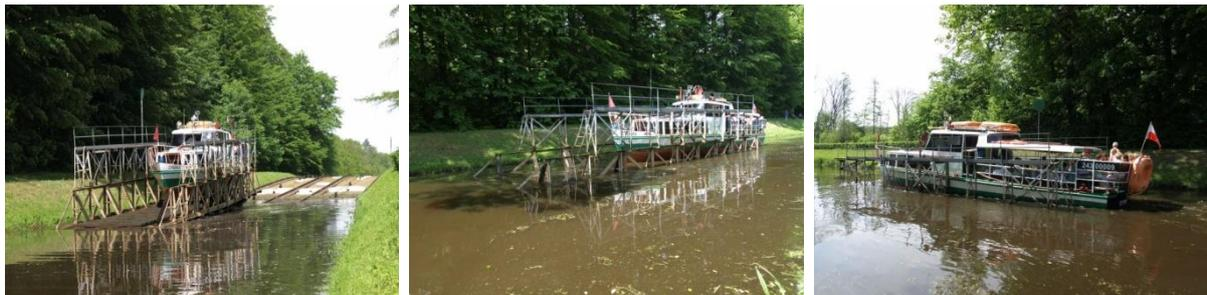
Das Schiff kommt mit dem Rollwagen über den Rollberg, rollt ins Wasser und schwimmt davon.
